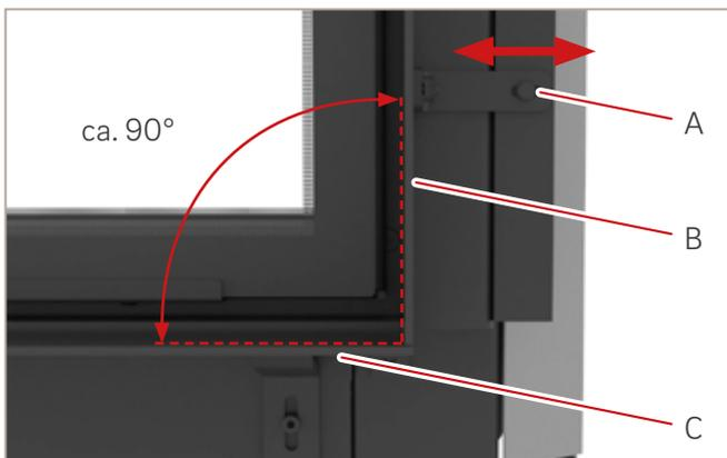
Abb. 18: BRS Seitenteil links/rechts justieren
