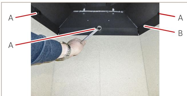
Abb. 21: Befestigungsschrauben lösen
