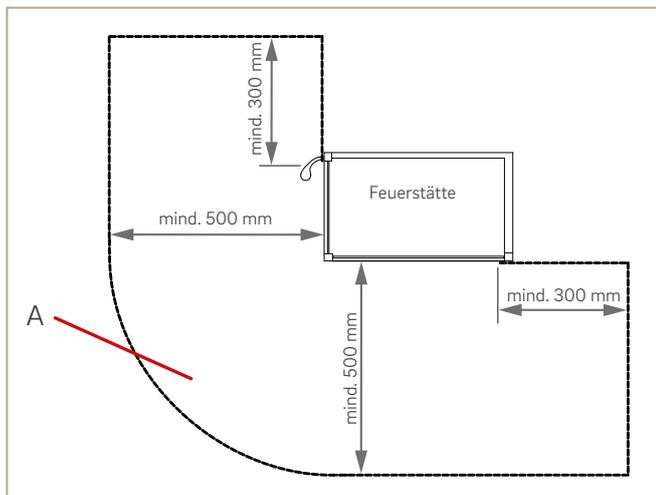
Abb. 64: Belag aus nicht brennbaren Baustoffen im Bereich vor der Feuerraumöffnung.
