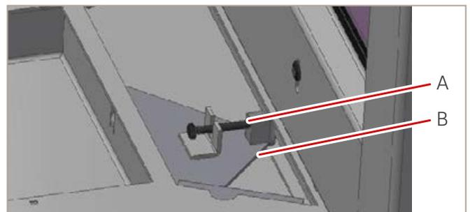
Abb.47: Befestigungsschraube lösen
