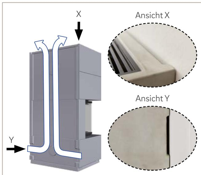
Abb. 66: Aktive Hinterlüftung mit Öffnungen seitlich und oben
