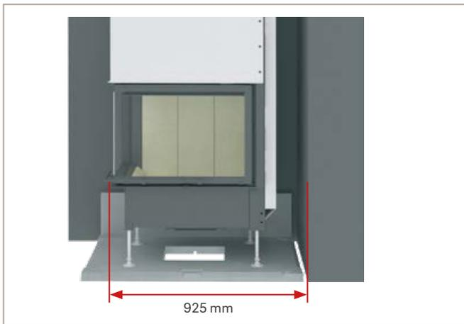
Abb. 21: Kamineinsatz Abstand zur seitlichen Wand bei Eckaufbau
