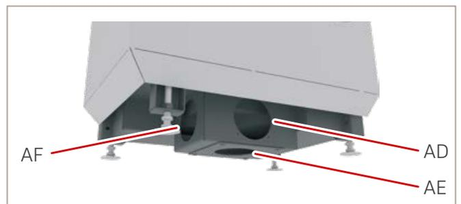
Abb. 23: Anschlussöffnungen Verbrennungsluft
