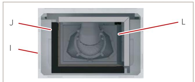
Abb.31: Sturzblende positionieren - Ansicht von oben
