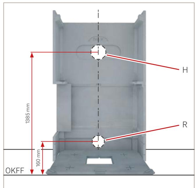
Abb. 34: Anschlüsse an der Zimmerwand anzeichnen und bohren
