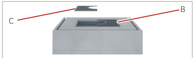
Abb. 38: Deckengitter einsetzen
