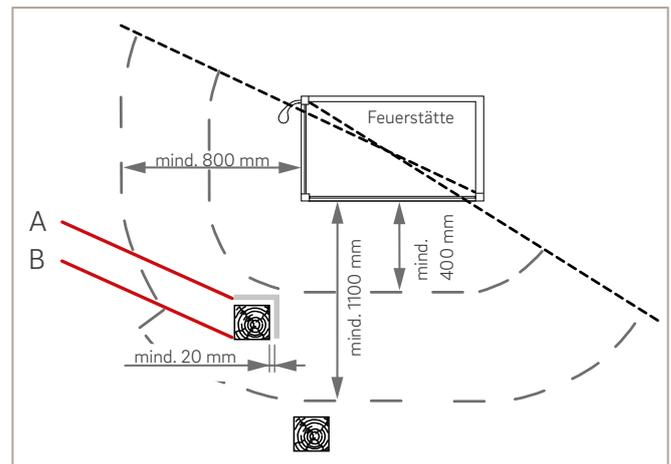
Abb. 65: Schutz von brennbaren Bauteilen im Strahlungsbereich vor der Feuerraumöffnung
