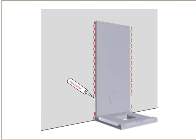
Abb. 35: Rückseite mit Zimmerwand verkleben, schematische Darstellung
