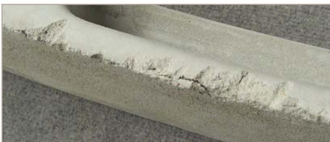
Abb. 60: Beispiel oberflächliche Abplatzungen
