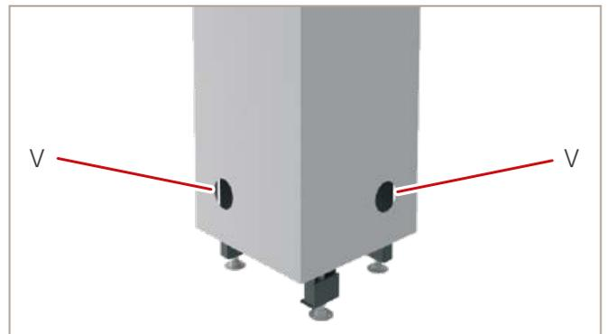
Abb. 15: Position Durchgangsöffnung im Strahlungsblech zur Feststellschraube am Kamineinsatz
