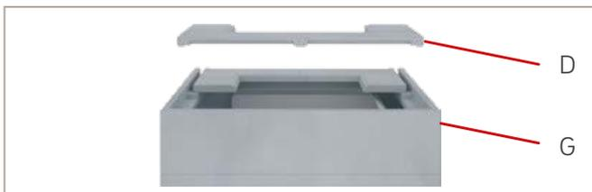
Abb. 37: Deckenplatte vorn einsetzen
