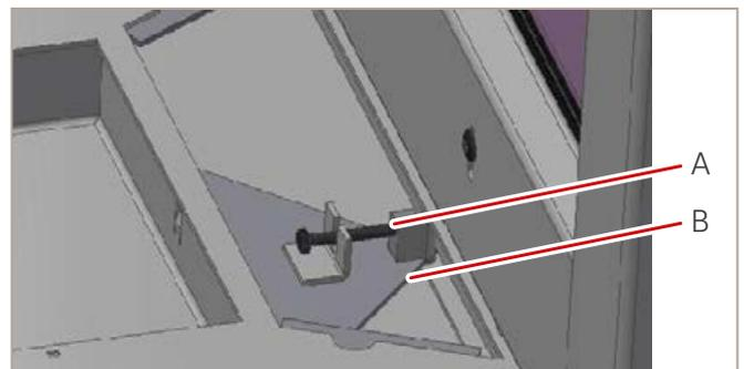
Abb. 57: Befestigungsschraube lösen
