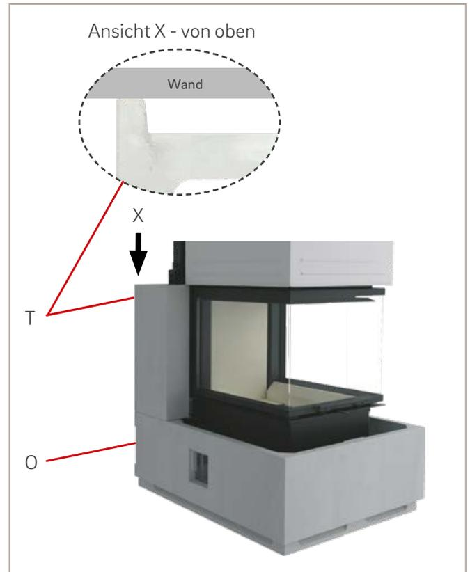
Abb. 39: Seitenteil lang setzen
