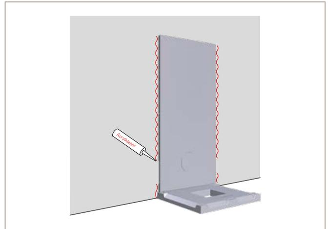
Abb. 46: Rückseite mit Zimmerwand verkleben, schematische Darstellung
