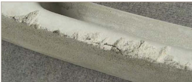
Abb. 69: Beispiel oberflächliche Abplatzungen
