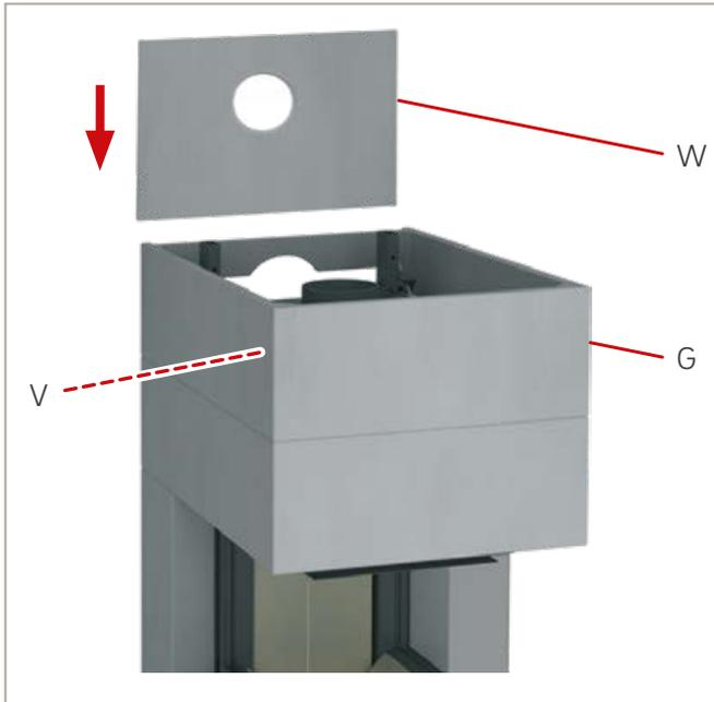
Abb. 44: Rückwand 3 setzen
