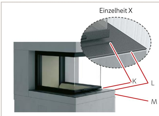
Abb. 54: Bankplatte setzen
