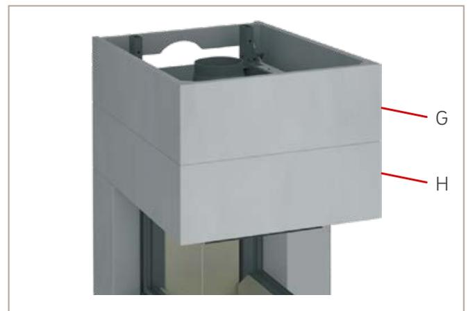
Abb. 43: Oberbauteil 2 setzen
