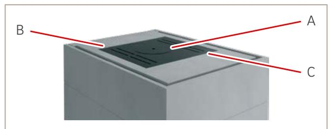
Abb.52: Deckengitter Deckel einsetzen
