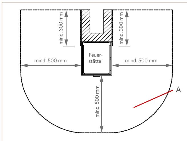
Abb. 73: Belag aus nicht brennbaren Baustoffen im Bereich vor der Feuerraumöffnung
