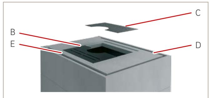
Abb.51: Deckengitter einsetzen
