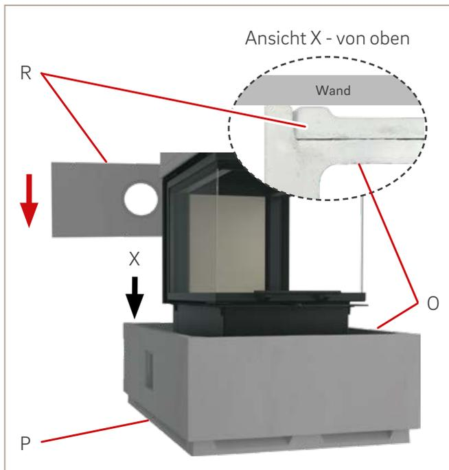
Abb. 38: Rückwand 1 setzen
