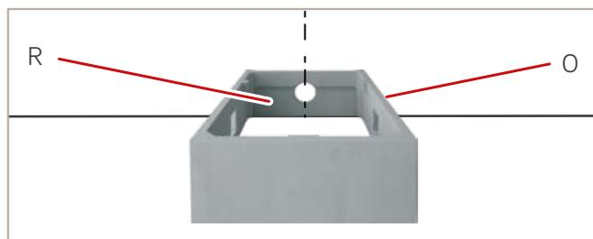
Abb. 21: Unterbauteil setzen
