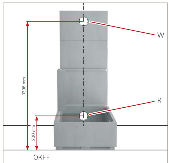
Abb. 19: Anschlüsse an der Zimmerwand anzeichnen und bohren
