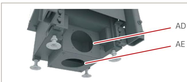
Abb. 33: Anschlussöffnungen Verbrennungszuluft
