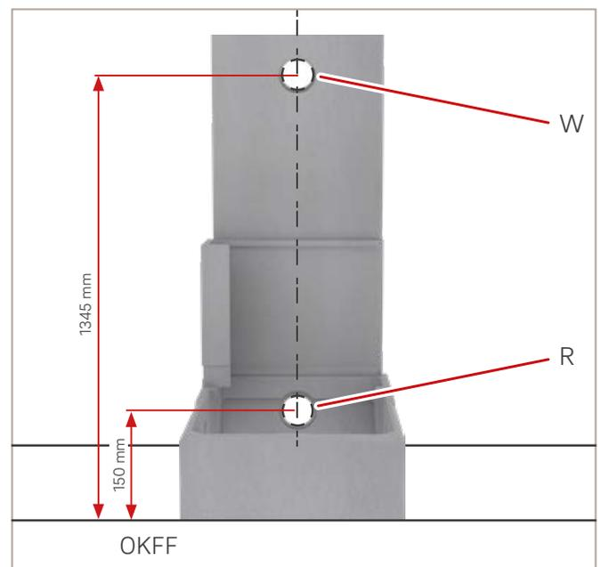
Abb. 24: Anschlüsse an der Zimmerwand anzeichnen und bohren
