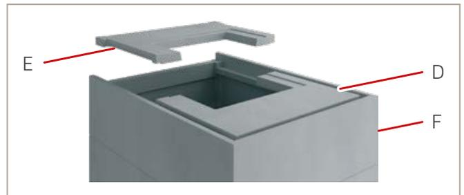
Abb.50: Deckenplatten einsetzen
