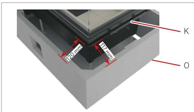
Abb. 36: Kamineinsatz ausrichten
