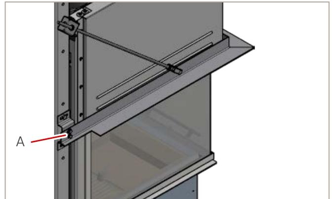
Abb. 6: Befestigungsschrauben lösen
