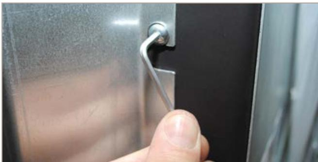
Abb. 23: Strahlungsblech montieren
