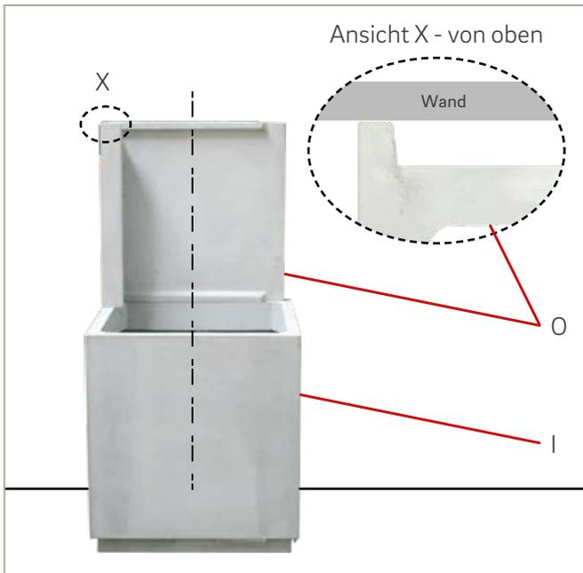
Abb. 10: Seitenteil lang setzen
