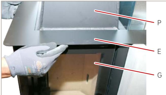
Abb. 29: Sturzblende positionieren
