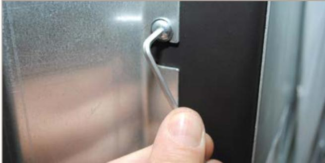
Abb. 21: Strahlungsblech demontieren
