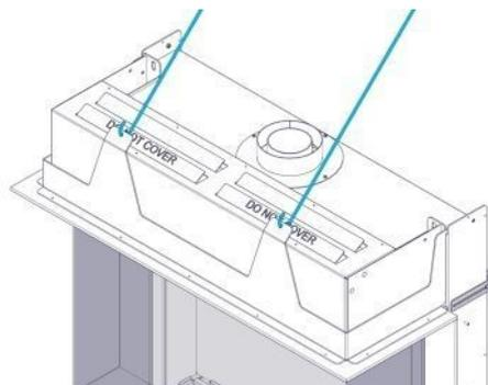
3. Vergewissern Sie sich, dass die Haltestangen in einem Winkel von 60° zum Gaskamin stehen.
