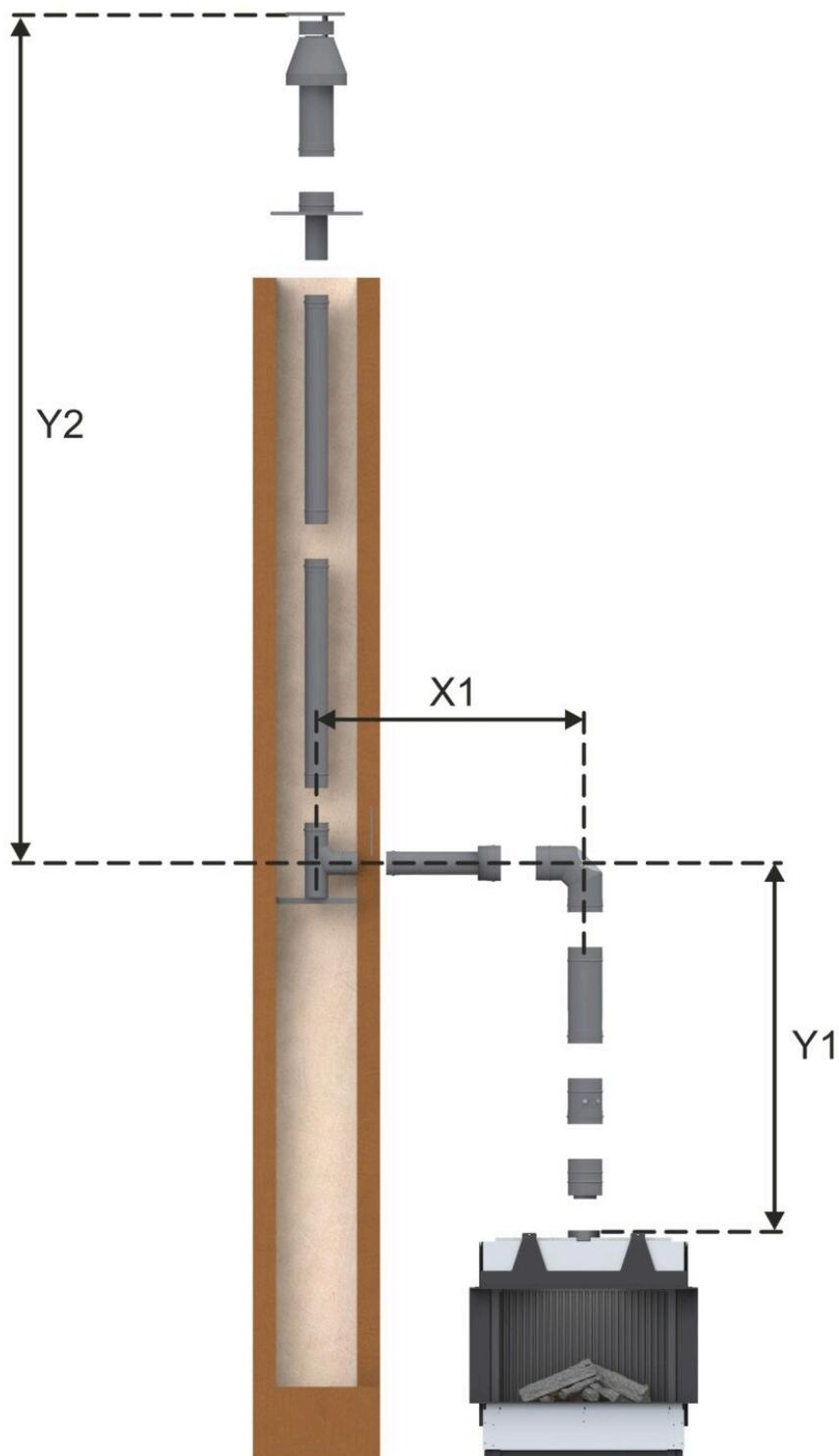
**LAS Nr. 5: Rohrführung D=100/150 mm im Schacht (C<sub>91</sub>; Abgasstutzen D=100/150 mm)**
