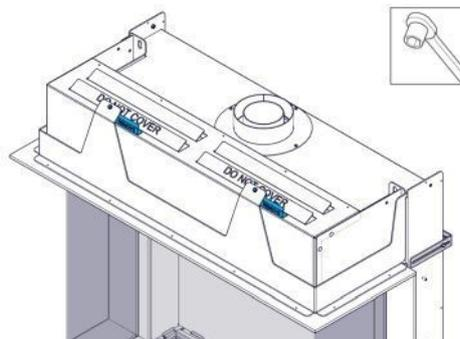
2. Verwenden Sie die 2 Haltestangen, um den Tragrahmen an der Rückwand zu fixieren.
