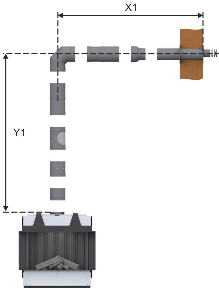
**LAS Nr. 12: Außenwandanschluß D=100/150 mm mit Reduzierung vor Abgasmündung (C<sub>11</sub>; Abgasstutzen D=130/200 mm)**
