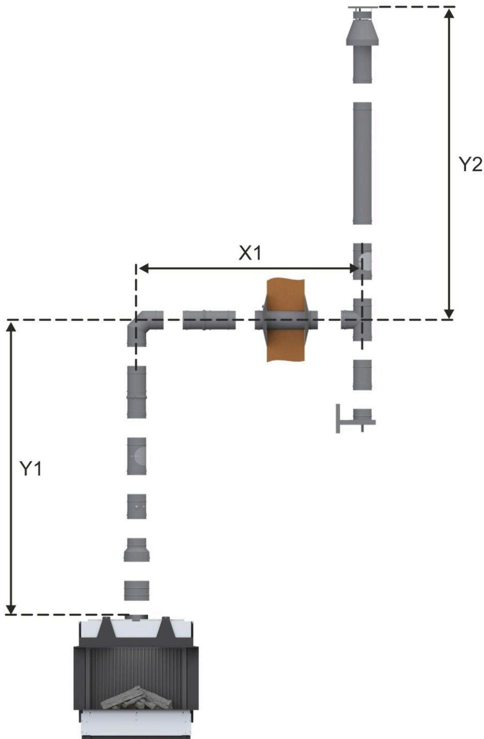
**LAS Nr. 8: Außenschornstein D=100/150 mm mit Abgasmündung über Dach (C<sub>31</sub>; Abgasstutzen D=130/200 mm)**
