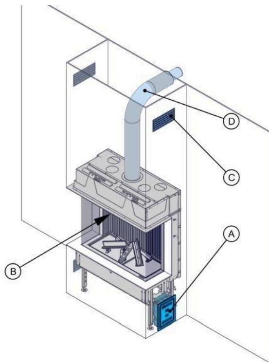
Abbildung 1: Typische Installation eines Gaskamins ohne Konvektionsmantel
