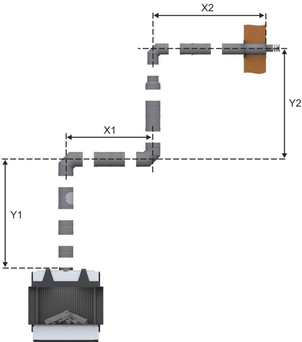
**LAS Nr. 14: Außenwandanschluß D=100/150 mm mit horizontalem und vertikalem Abschnitt und Reduzierung (C<sub>11</sub>; Abgasstutzen D=130/200 mm)**
