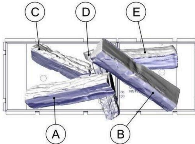
Abbildung 10: Positionen der Holzimitate und Brennerleisten
