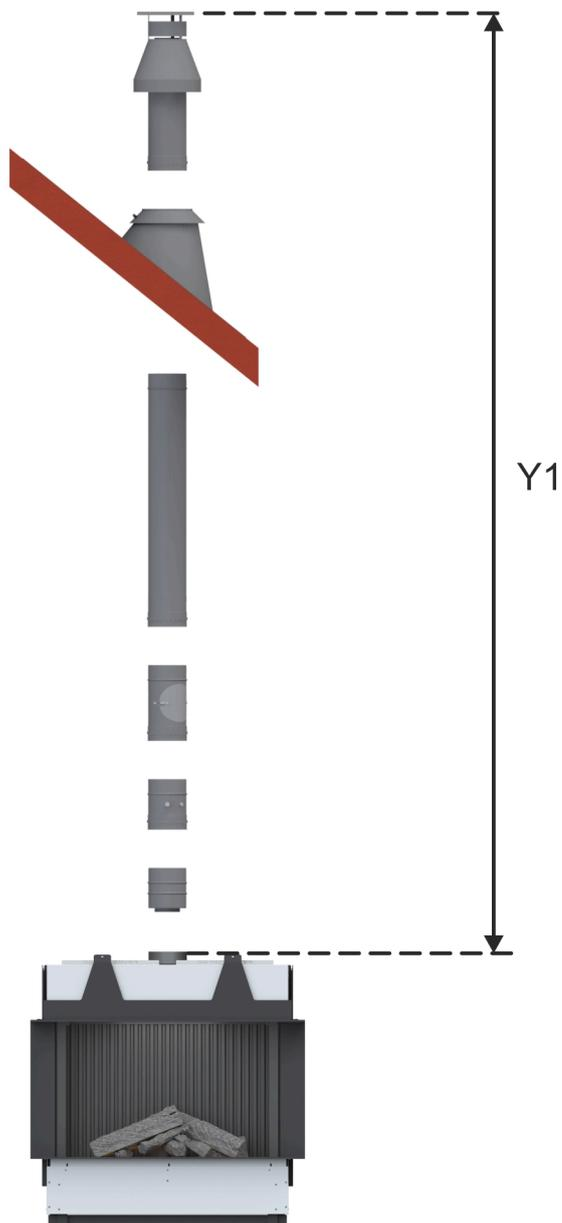
**LAS Nr. 1: vertikale Rohrführung D=100/150 mm mit Abgasmündung über Dach (C<sub>31</sub>; Abgasstutzen D=100/150 mm)**
