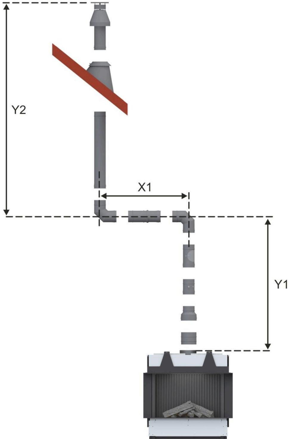
**LAS Nr. 4: vertikale Rohrführung D=100/150 mm mit horizontalem Abschnitt und Abgasmündung über Dach (C<sub>31</sub>; Abgasstutzen D=130/200 mm)**
