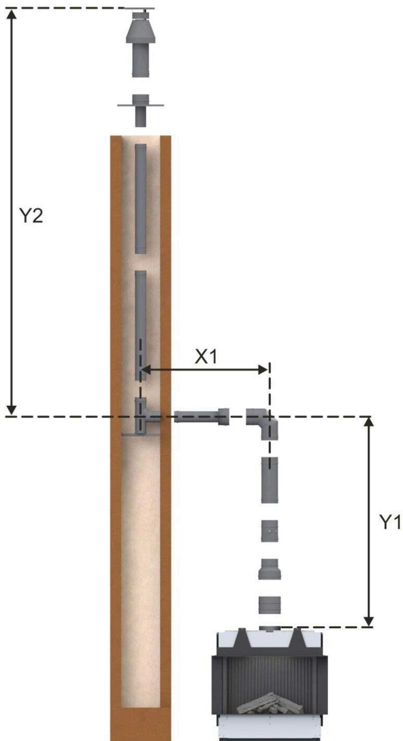
**LAS Nr. 6: Rohrführung D=100/150 mm im Schacht (C<sub>91</sub>; Abgasstutzen D=130/200 mm)**
