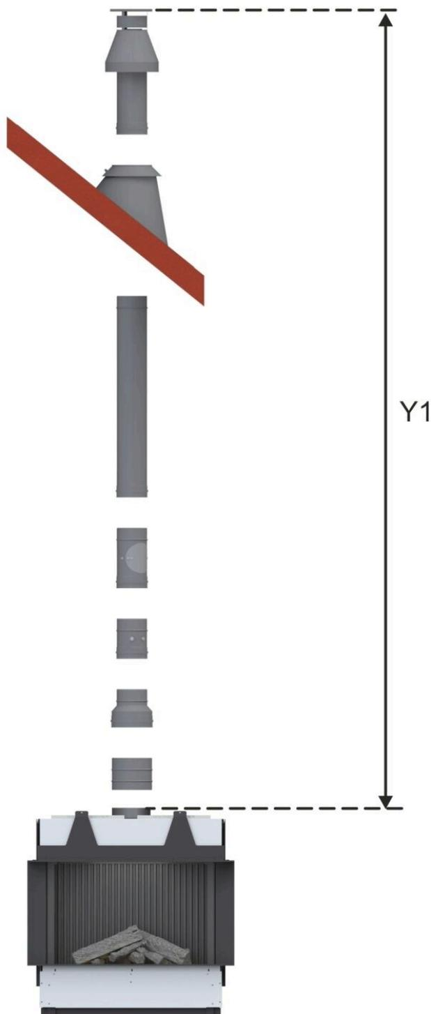
**LAS Nr. 2: vertikale Rohrführung D=100/150 mm mit Abgasmündung über Dach (C<sub>31</sub>; Abgasstutzen D=130/200 mm)**
