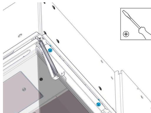
4. Montieren Sie die Frontglasscheibe, indem Sie die Scheibe etwas schräg anheben und in den Leisten (Oberseite und Unterteil) platzieren.
