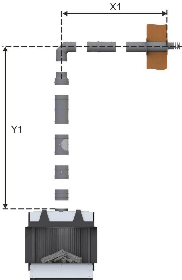
**LAS Nr. 11: Außenwandanschluß D=100/150 mm mit Reduzierung vor Rohrbogen (C<sub>11</sub>; Abgasstutzen D=130/200 mm)**
