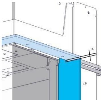
7. Kontrollieren Sie, daß das Auflager links und rechts rechtwinklig zu den seitlichen Blendenteilen steht.
