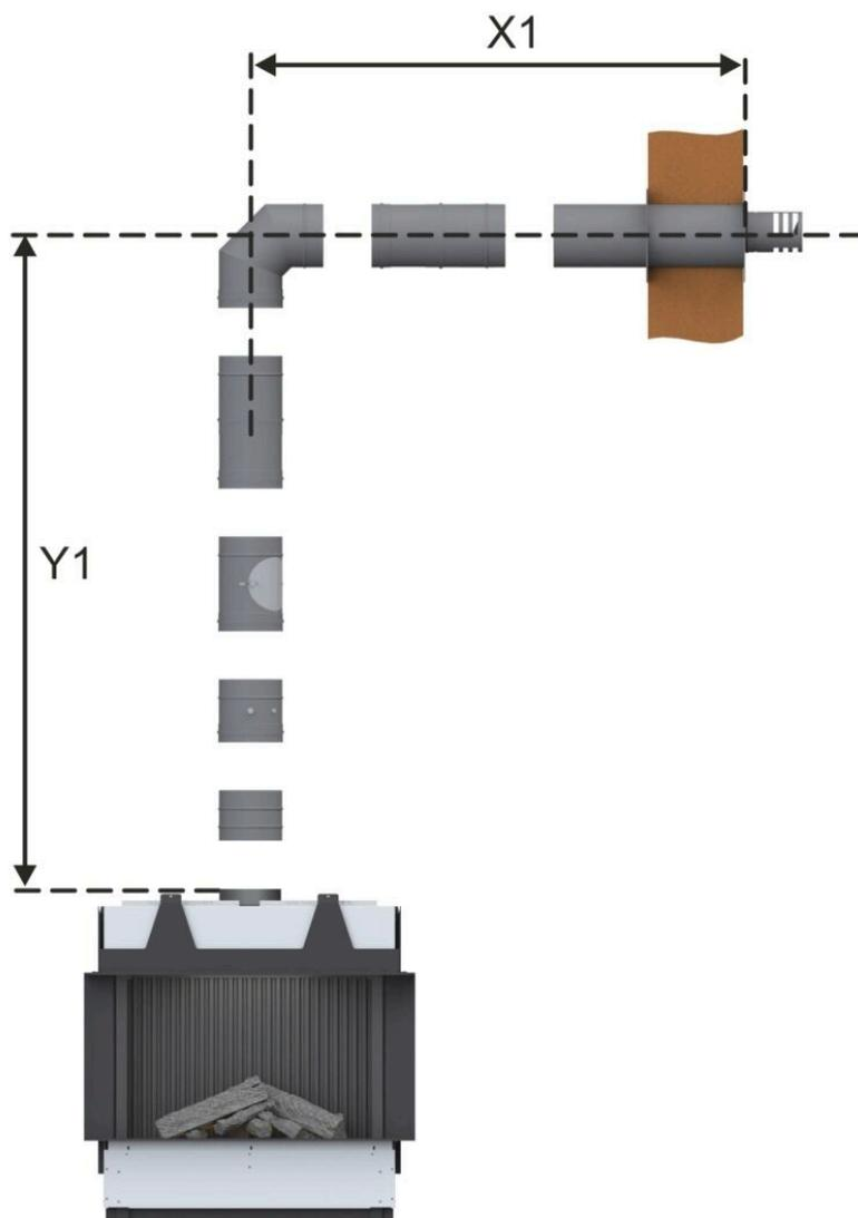
**LAS Nr. 13: Außenwandanschluß D=130/200 mm (C<sub>11</sub>; Abgasstutzen D=130/200 mm)**
