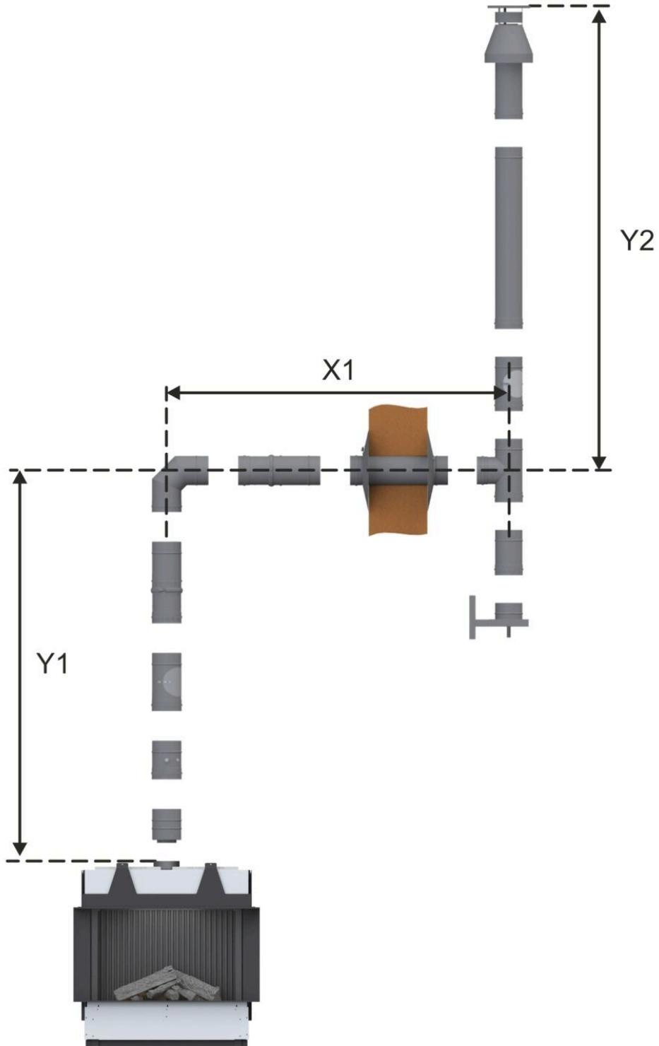
**LAS Nr. 7: Außenschornstein D=100/150 mm mit Abgasmündung über Dach (C<sub>31</sub>; Abgasstutzen D=100/150 mm)**
