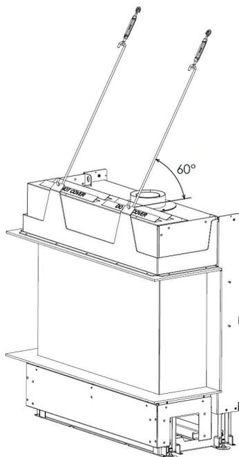
4. Richten Sie das Auflager mit den Spannschlössern aus. Verwenden Sie dazu eine Wasserwaage.
