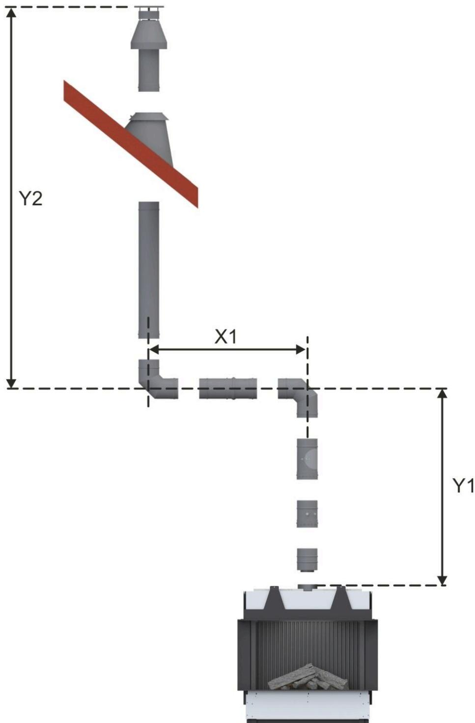
**LAS Nr. 3: vertikale Rohrführung D=100/150 mm mit horizontalem Abschnitt und Abgasmündung über Dach (C<sub>31</sub>; Abgasstutzen D=100/150 mm)**
