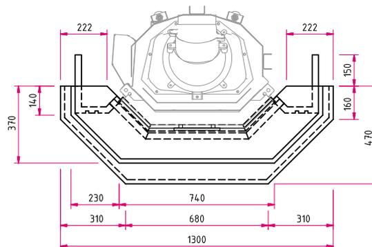
**Hinweis Seitenansicht M 1:25:** AS: Abgasstutzen, VLS: Verbrennungsluftstutzen, OKFF: Oberkante Fertigfußboden
