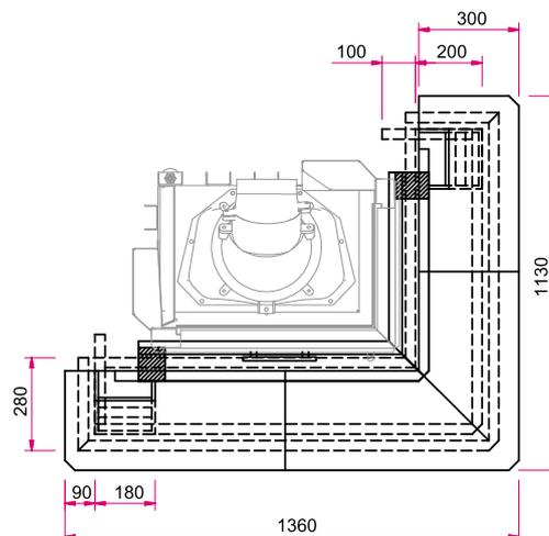
**Hinweis Seitenansicht M 1:25:** AS: Abgasstutzen, VLS: Verbrennungsluftstutzen, OKFF: Oberkante Fertigfußboden
