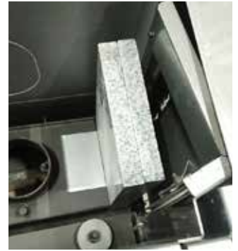
Die zwei langen Steinplatten wie abgebildet positionieren.
