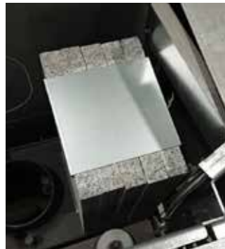
Das Halteblech mit U-Form wie oben abgebildet über die Steinplatten stecken.
