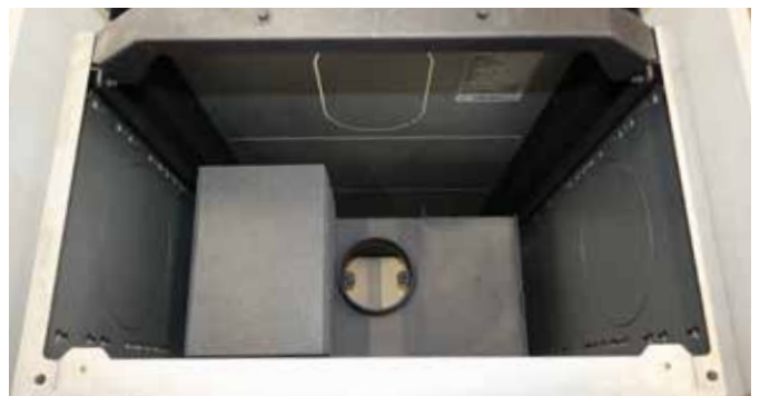
Nun die 10 Steinplatten mit 3 cm bzw. 15 Steinplatten mit 2 cm wie abgebildet einlegen.
