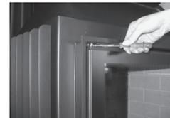
2. Schwenken Sie die Tür auf. Anschließend ziehen Sie die Innensechskantschraube am unteren Scharnier mit einem 3 mm Sechskantschlüssel fest.
