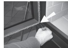
3. Erfassen Sie die Tür von unten. Mit einer leichten Hubbewegung heben Sie die Tür etwas an, damit der untere Zapfen des Scharniers freiliegt.
